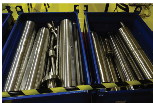
Right: Example of dry packaging: Control rod drive mechanisms in box pallets Source: Jadrová a vyraďovacia spoločnosť, a.s.
